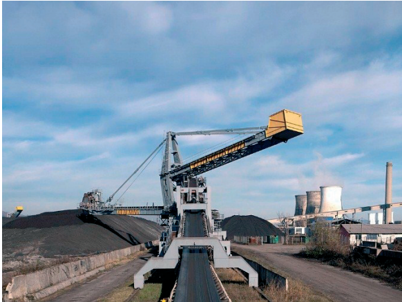
Masina combinata (depunere carbune si preluare carbune din stiva) MC1c
